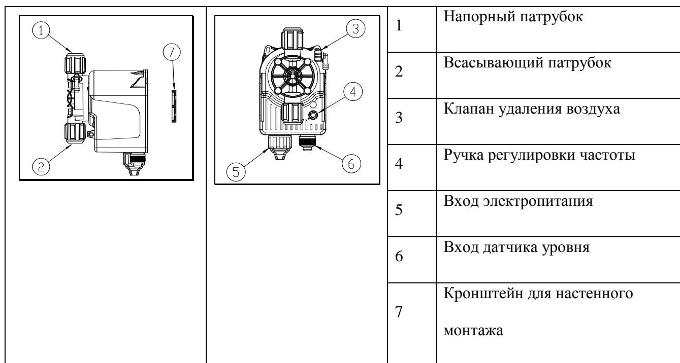
Рис. 10. Составные части насоса
